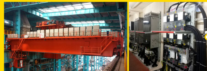
广西盛隆冶金 5 台 300T 铸造吊 主钩电机 450KW×2 QY2-2000S/T5 380V 一拖二驱动
