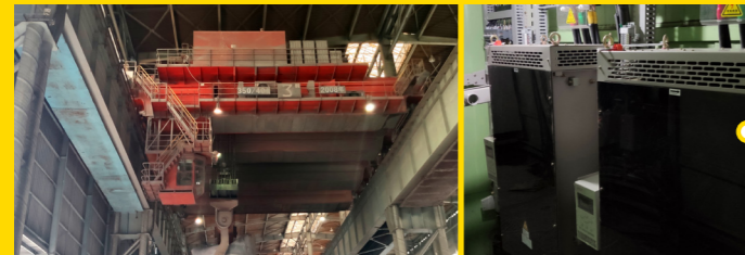
重庆钢铁 2 台 350T 铸造吊 主钩电机 620KW×2 原ABB调压改造为QY3-1000S-A 690V 2台一拖一驱动
