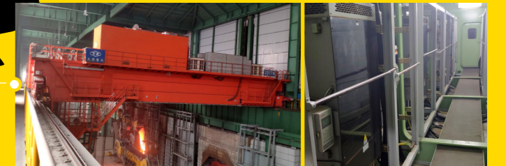
河北纵横钢铁 13 台 350T 铸造吊 主钩电机 560KW×2 QY3-2000S-A 500V 一拖二驱动
