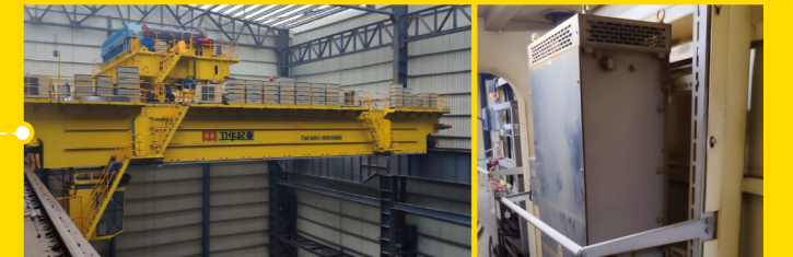
丽水华宏钢铁 2 台 240T 铸造吊 主钩电机 315KW×2 QY2-1500S/T5 380V 一拖二驱动
